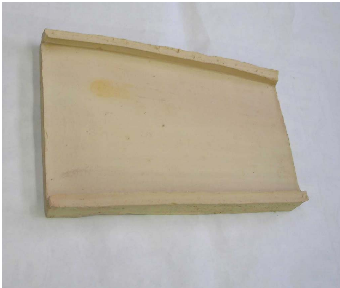
Figura 1. Riproduzione fotografica di un provino tal quale del prodotto “ Tegola in Cotto fatta a Mano ”.
